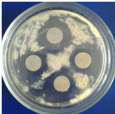
Рис. 10. Зоны подавления роста Aspergillus niger 0,2%-ным раствором азотнокислого серебра в Na-карбоксиметилцеллюлозе с соотношением «ядро-оболочка» 1:2
