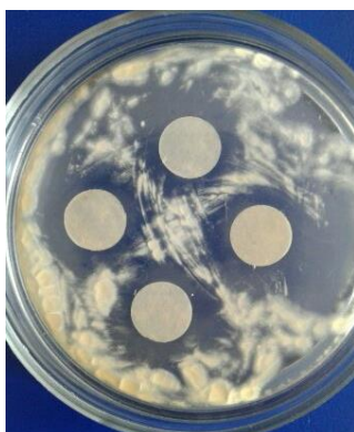
Рис. 12. Зоны подавления роста Aspergillus niger 0,15%-ным раствором азотнокислого серебра в Na-карбоксиметилцеллюлозе с соотношением «ядро-оболочка» 1:3
