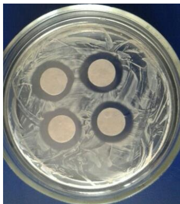
Рис. (№). Зоны подавления роста Staphylococcus aureus 0,15%-ного раствора чистого азотнокислого серебра
