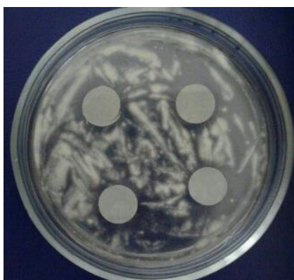
Рис. 22. Зоны подавления роста Aspergillus niger 0,2%-ным раствором азотнокислого серебра в желатиновой камеди с соотношением «ядро-оболочка» 1:2
