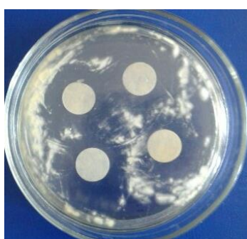
Рис. 6. Зоны подавления роста Aspergillus niger 0,15%-ным раствором азотнокислого серебра в Na-карбоксиметилцеллюлозе с соотношением «ядро-оболочка» 1:1
