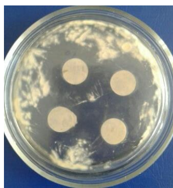
Рис. 4. Зоны подавления роста Aspergillus niger 0,2%-ным раствором азотнокислого серебра
