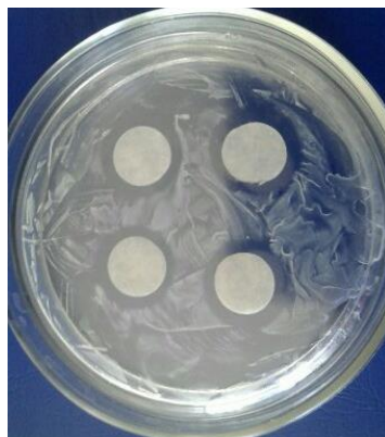
Рис. 15. Зоны подавления роста Staphylococcus aureus 0,2%-ного раствора азотно-кислого серебра в На-карбоксиметилцеллюлозе с соотношением «ядро-оболочка» 1:3
