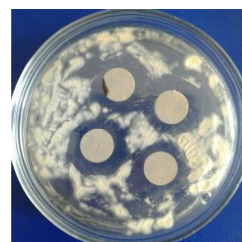
Рис. 8. Зоны подавления роста Aspergillus niger 0,25%-ным раствором азотнокислого серебра в Na-карбоксиметилцеллюлозе с соотношением «ядро-оболочка» 1:1
