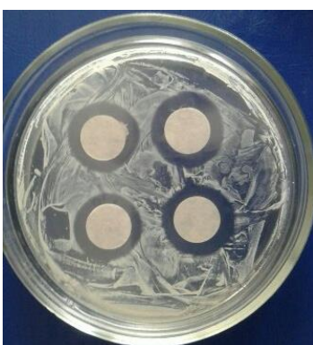
Рис. (№). Зоны подавления роста Staphylococcus aureus 0,2%-ного раствора азотнокислого серебра в желатиновой камеди с соотношением «ядро-оболочка» 1:2
