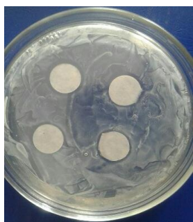
Рис. 11. Зоны подавления роста Staphylococcus aureus 0,15%-ного раствора азотнокислого серебра в Na-карбоксиметилцеллюлозе с соотношением «ядро-оболочка» 1:2
